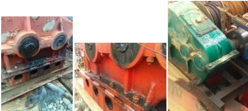
Estos son casos detectados en el periodo que debieron sacarse de operación o al menos utilizar medidas extraordinarias para evitar contaminación por mal estado de los equipos.
