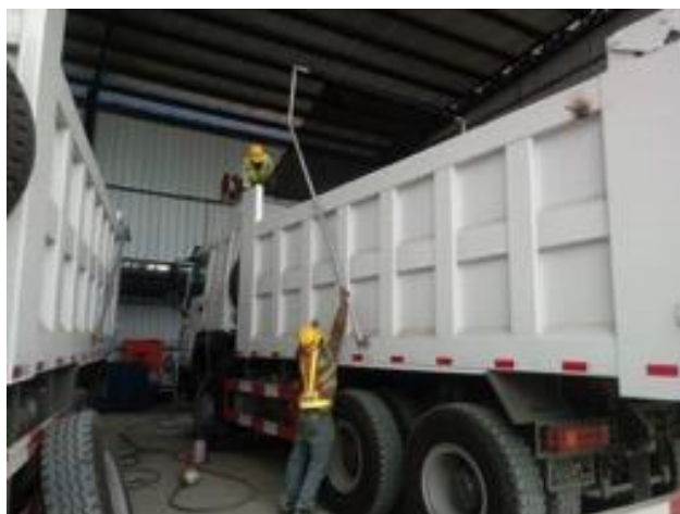
Figura 18. Instalación de lona a vagonetas nuevas.
