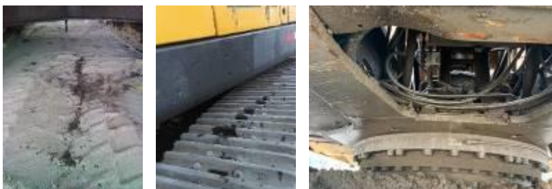
Fot. Izquierda y centro: La excavadora #5 presenta fugas de aceite en los pistones y en el motor. Derecha: En plantel Barbilla, se observa maquinaria en reparación fuera del taller, que presenta derrame de aceite.
