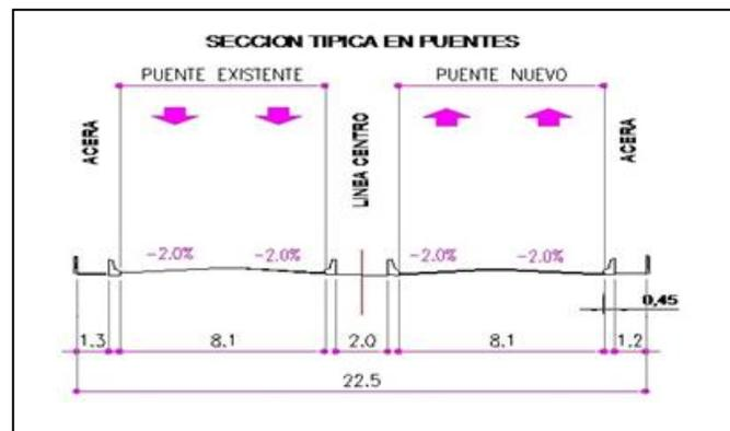
En las secciones típicas no se señalan las estructuras de drenajes y evacuaciones pluviales, por lo que se deberá de contemplar en los diseños definitivos según estudios hidrológicos.
